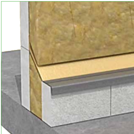
Eindsituatie na aanbrengen isolatie.
