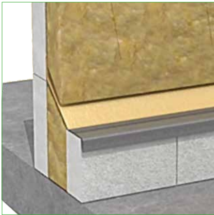
Eindsituatie na aanbrengen isolatie.
